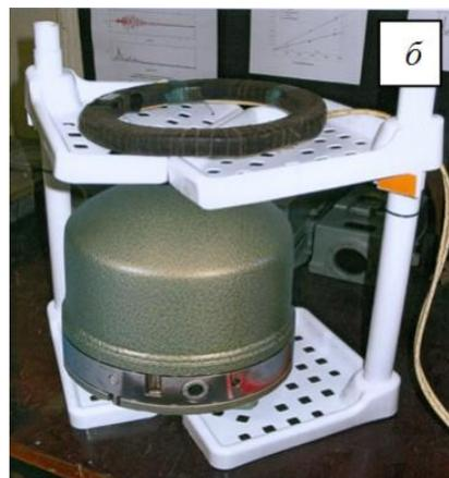
Рисунок 1. Общий вид лабораторного оборудования эксперимента по проверке воздействия магнитного поля на сейсмометры: (а) – CM-3KB; (б) – STS-2
