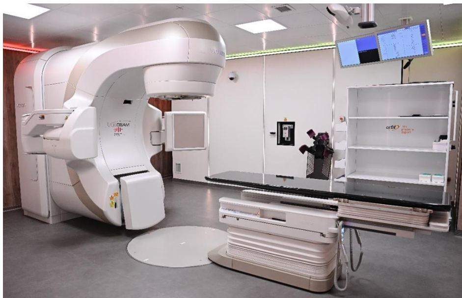
Рисунок 1. Линейный ускоритель TrueBeam (Varian Medical Systems Inc., США)
