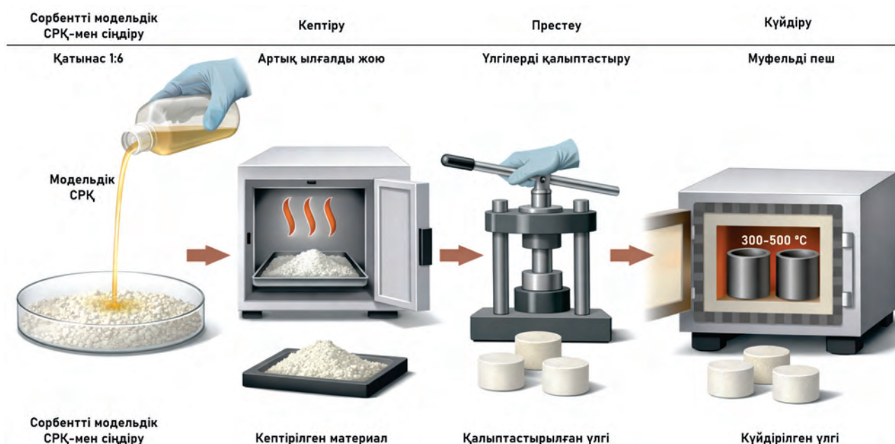
1-сурет. Күйдірілген үлгілерді алудың технологиялық сызбасы (иллюстрация ЖИ көмегімен жасалған)
