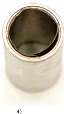
2-сурет. Вольфрам тигелінің (а) және күйдірілген үлгінің (б) сыртқы көрінісі
