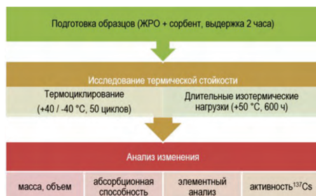
Рисунок 2. Схема исследования термической стойкости
