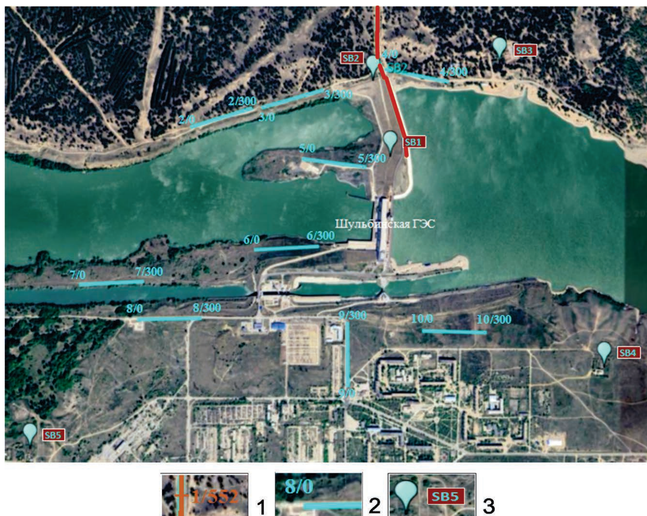
1, 2 – профили сейсморазведочных зондирований первого (1) и второго (2) этапов; 3 – точки расположения сейсмологических станций (SB).
