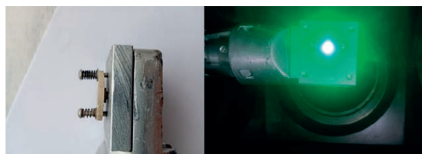
Рисунок 2. Внешний вид мишени с образцом внутри и в ускорителе
