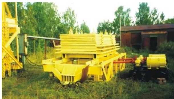
Рисунок 4. Вибрационный источник ЦВ-40 с амплитудой возмущающей силы 40 тс и полосой рабочих частот 6,25–11,23 Гц
