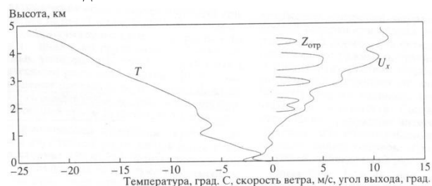
а) высотные (в км) профили температуры T , компоненты горизонтального ветра U_x (м/с) по данным радиозонда (для 5ч 30 мин местного времени, летнее время), высоты отражения Z_{отр}
