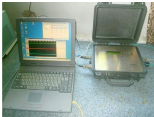
Рисунок 4. Сервер Scream (слева) и регистратор CMG-DM24 (справа)
