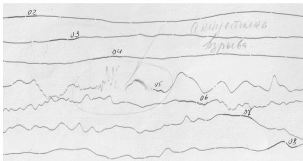
Рисунок 8. Фрагмент записи микробарографа TLG с акустическим сигналом взрыва в Медео 21.10.1966 г.
