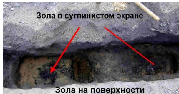
Темные пятна в кровле суглинистого экрана – остатки струй фильтровавшейся золы, светло-серые – суглинок без признаков присутствия золы
