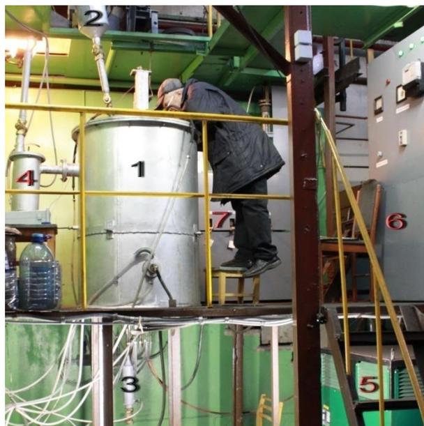
1 - реактор; 2 - загрузочное устройство; 3 - устройство для выгрузки; 4 - очиститель сбросных газов; 5 - силовой трансформатор; 6 - контрольно-измерительные приборы; 7 - пульт газоподготовки
