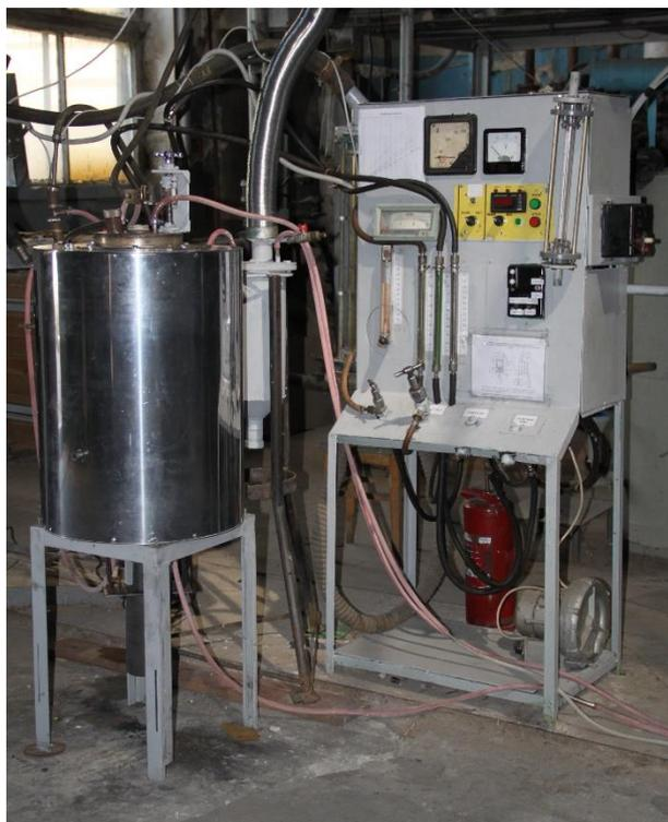
Рисунок 1. Лабораторная установка для высокотемпературной очистки графита
