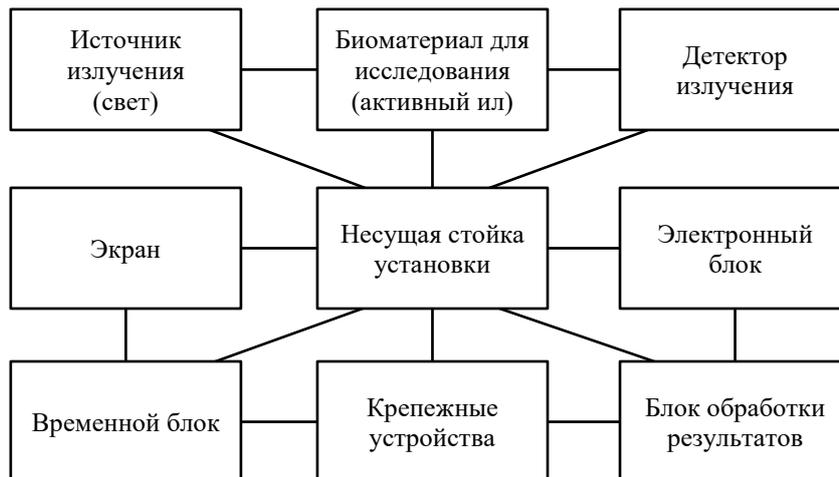
Рисунок 1. Схема эксперимента по прохождению излучений через биоматериал
