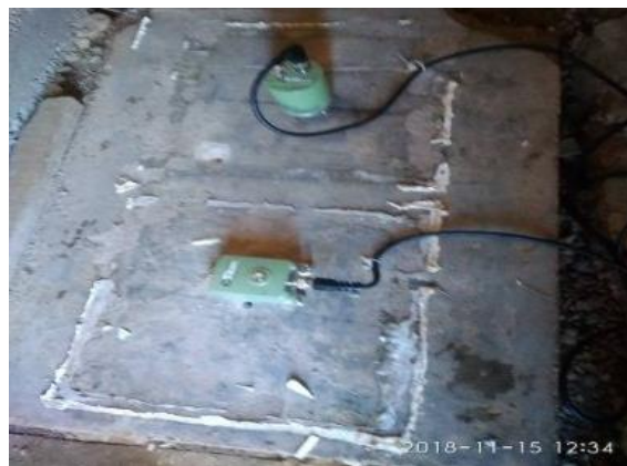
а) сейсмометр Trillium Compact и акселерометр Titan, 4g
