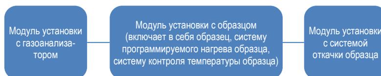
Рисунок 1. Блок-схема ТДС эксперимента (дифференциальный вариант) при нагреве исследуемого образца в условиях откачки камеры
