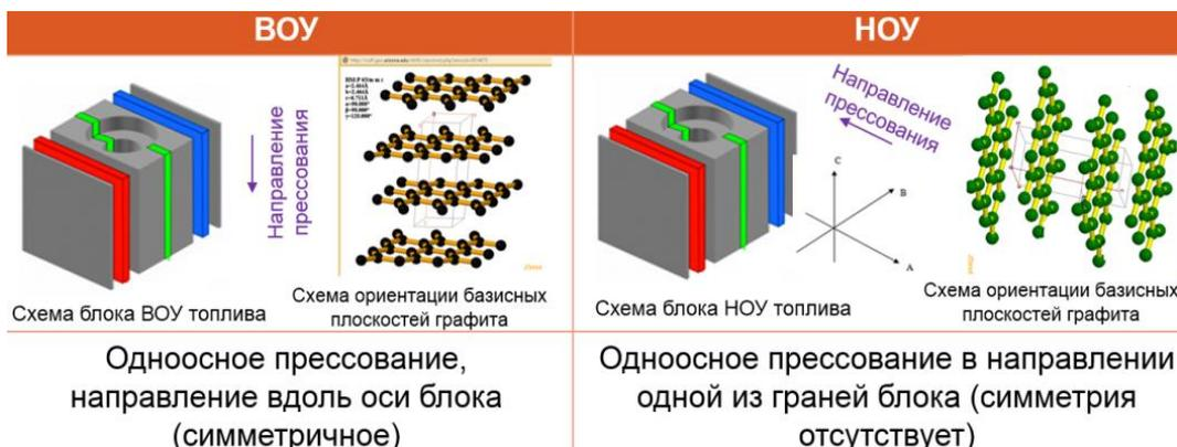
Рисунок 3. Определение преимущественной ориентации базисных плоскостей графита в блоках ВОУ и НОУ топлива
