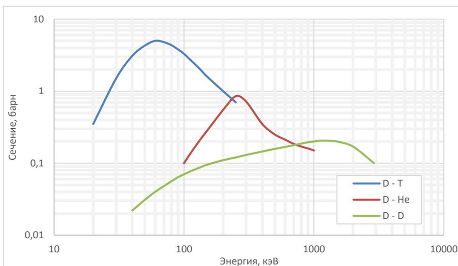
Рисунок 3. Зависимость сечений реакций синтеза от энергии
