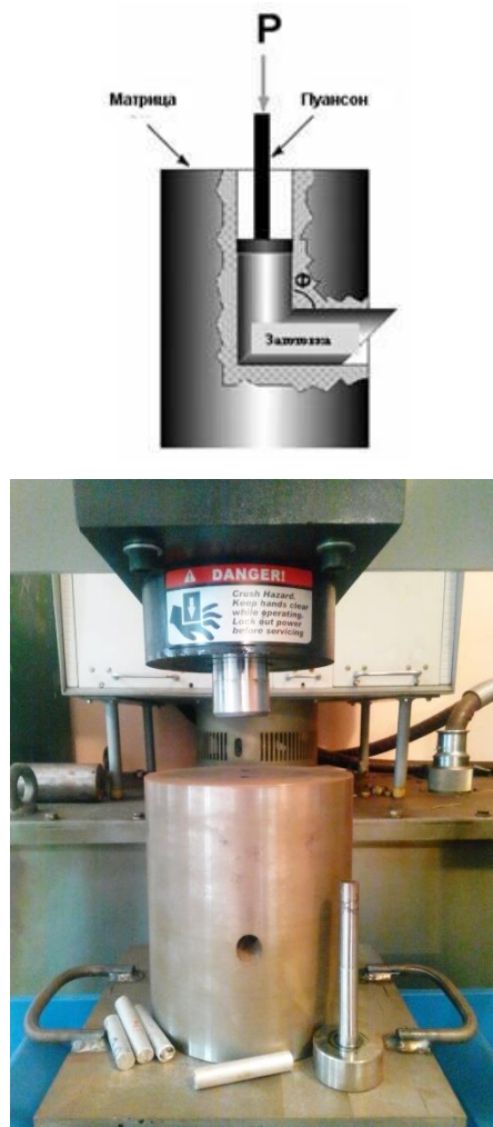
Рисунок 1. Схема проведения РКУП прессования и пресс-оснастка с гидравлическим прессом для интенсивной пластической деформации
