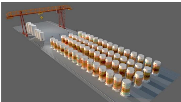
Рисунок 3. Модель площадки ДКХОЯТ с нанесением распределения по суммарной скорости счета \gamma -импульсов на УКХ
