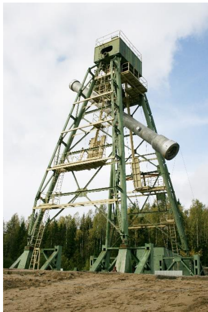
Рисунок 5. Исходное положение ТУК перед бросковыми испытаниями
