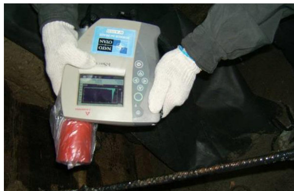
Рисунок 4. Характерная линия в спектре от ОЯД на мазке из концевой боксы на экране спектрометра при подтверждающих измерениях
