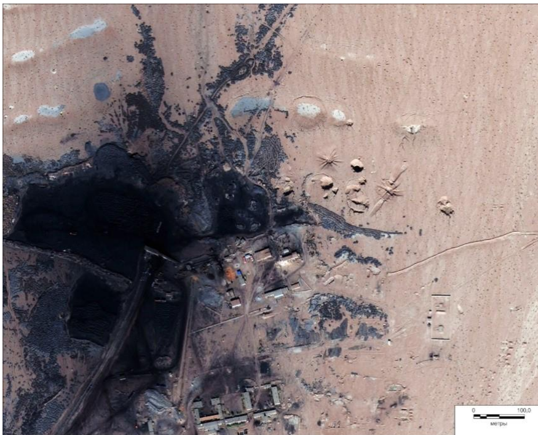
Рисунок 12. Снимок из SASPlanet района расположения угольного разреза, где с восточной стороны видны небольшие воронки диаметром от 6–15 м до 30 м и провалы земной поверхности размерами от 40×40 м до 80×100 м в чехле рыхлых мезозойских отложений, координата круглой воронки в центральной части снимка 41,73124° с.ш.; 88,73837° в.д.
