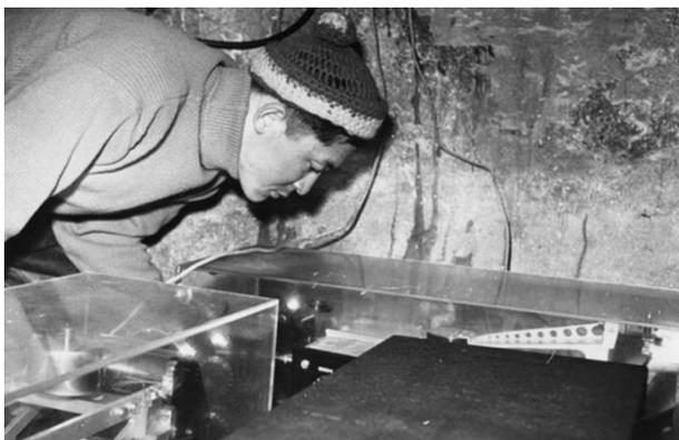
Рисунок 4. Переопределение постоянных сейсмометра на сейсмостанции «Мирный», 1959 г.
