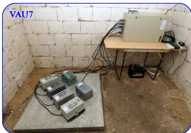
Рисунок 3. Пример установки сейсмической станции
