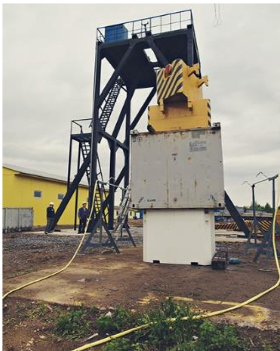
г) Испытание на штабелирование (сжатие с усилием)
