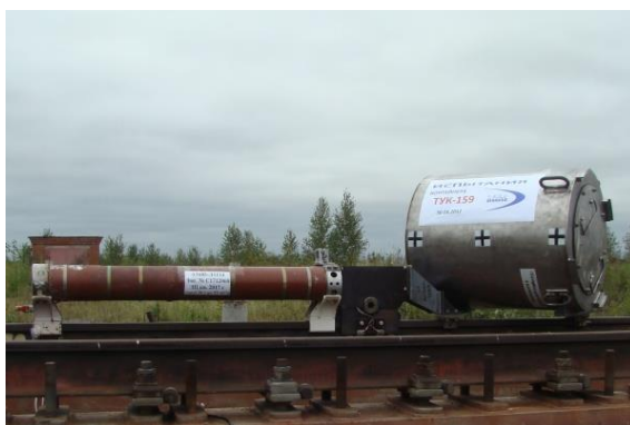
е) Испытание на столкновение
