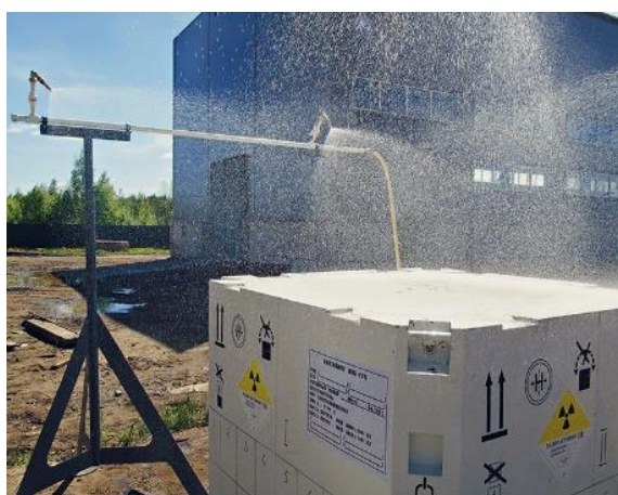
б) Стенд по обрызгиванию водой
