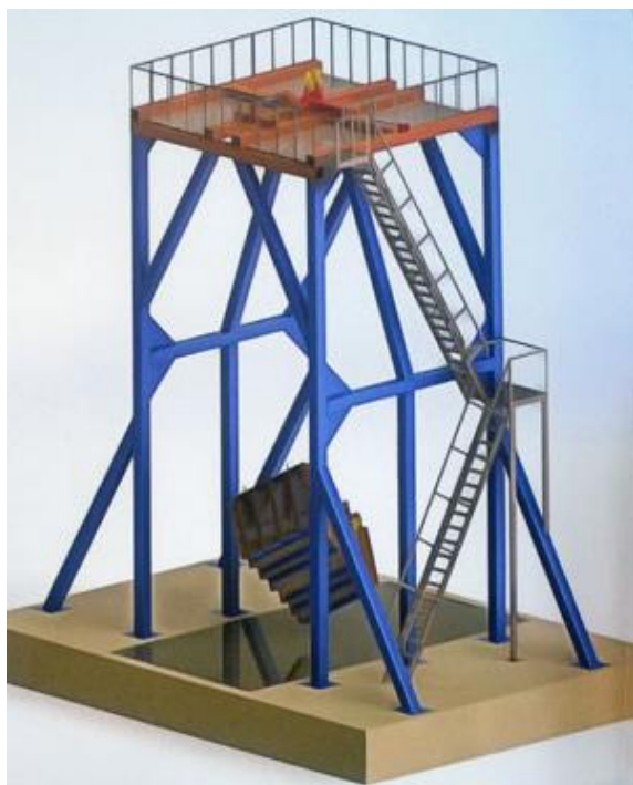
в) Стенд для проведения испытания на свободное падение
