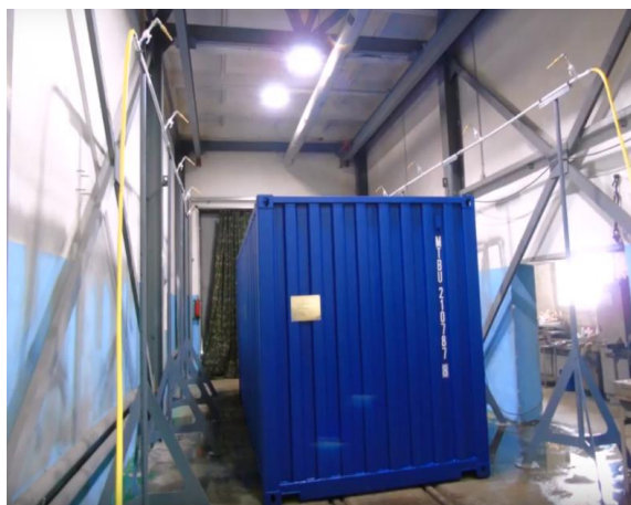
а) Стенд по обрызгиванию водой
