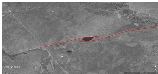
Рисунок 6. Лепсинский разлом по полевым наблюдениям и спутниковым снимкам, показывающим косое взбросовое правостороннее смещение с преобладанием вертикальных движений на востоке и без явных свидетельств горизонтальных смещений на западе [14]
