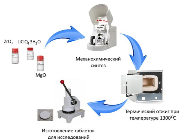
Рисунок 1. Схема получения литийсодержащих керамик
