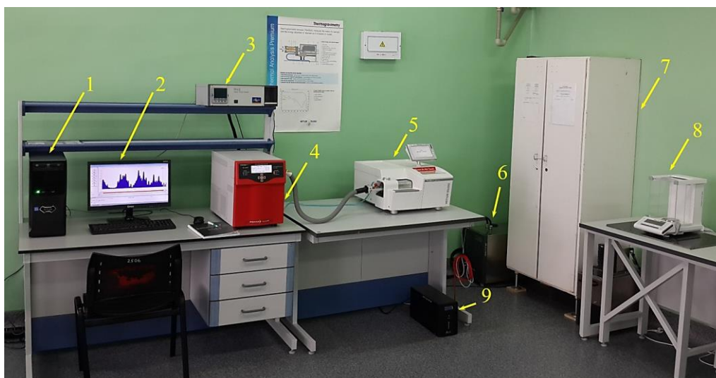
1 – процессор; 2 – монитор; 3 – генератор влажности; 4 – масс-спектрометр с прогреваемым капилляром; 5 – прибор TGA/DSC 3+; 6 – чиллер охлаждения; 7 – шкаф с инертными газами; 8 – аналитические весы; 9 – источник бесперебойного питания
