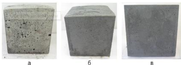
Рисунок 8. Внешний вид образцов (возраст 28 суток): а) состав с 3У ( B / (Ц + 3У + Г) = 0,32 , Ц/3У = 1 / 2,5 , цемент «Super 500»); б) состав с 3У ( B / (Ц + 3У + Г) = 0,38 , Ц/3У = 1 / 2,5 , цемент «Super 500»); в) состав с 3У ( B / (Ц + 3У + Г) = 0,48 , Ц/3У = 1 / 2,5 , цемент «Super 500»)
