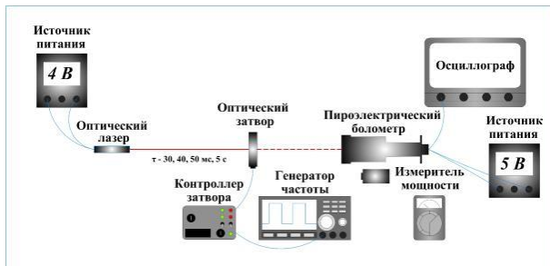
Рисунок 4. Принципиальная схема калибровки пирозлектрического болометра
