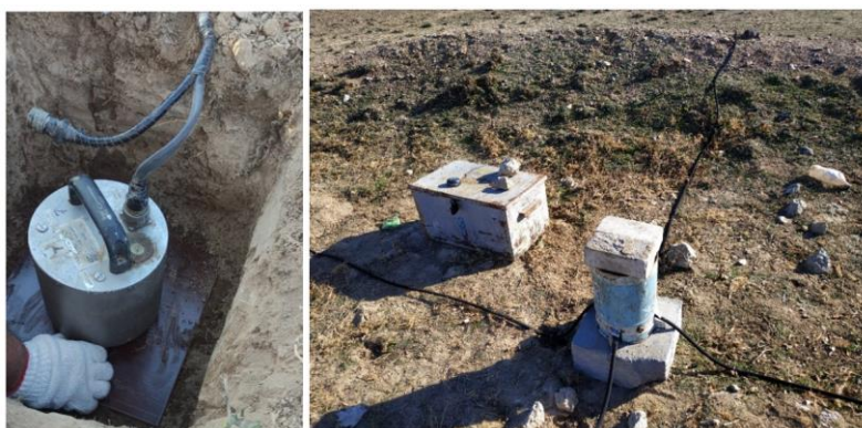
Рисунок 5. Общий вид места расположения записывающей аппаратуры, сейсмометра и микробарометра
