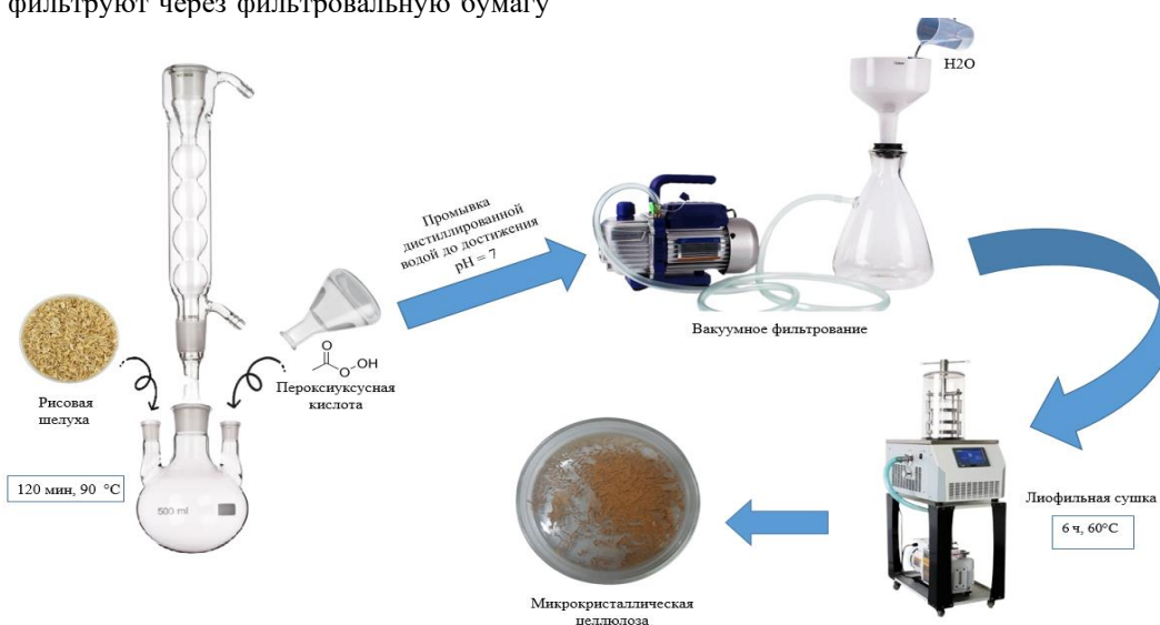
Рисунок 1. Схема получения микрокристаллической целлюлозы из рисовой шелухи
