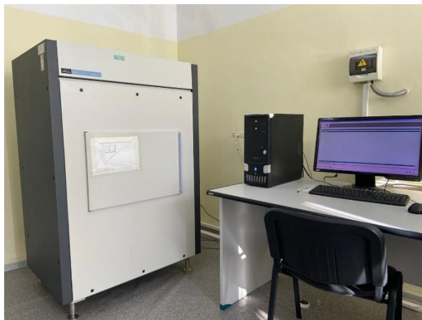
Рисунок 1. Жидкостной сцинтилляционный счетчик альфа-бета-излучения Quantulus 1220
