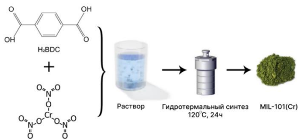
Рисунок 2. Схема получения MIL-101(Cr) гидротермальным методом
