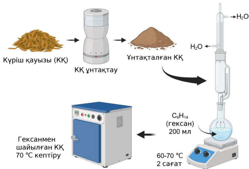
Сурет 1. БМ-ды ұнтақтау және гексанмен шаяу процестер
