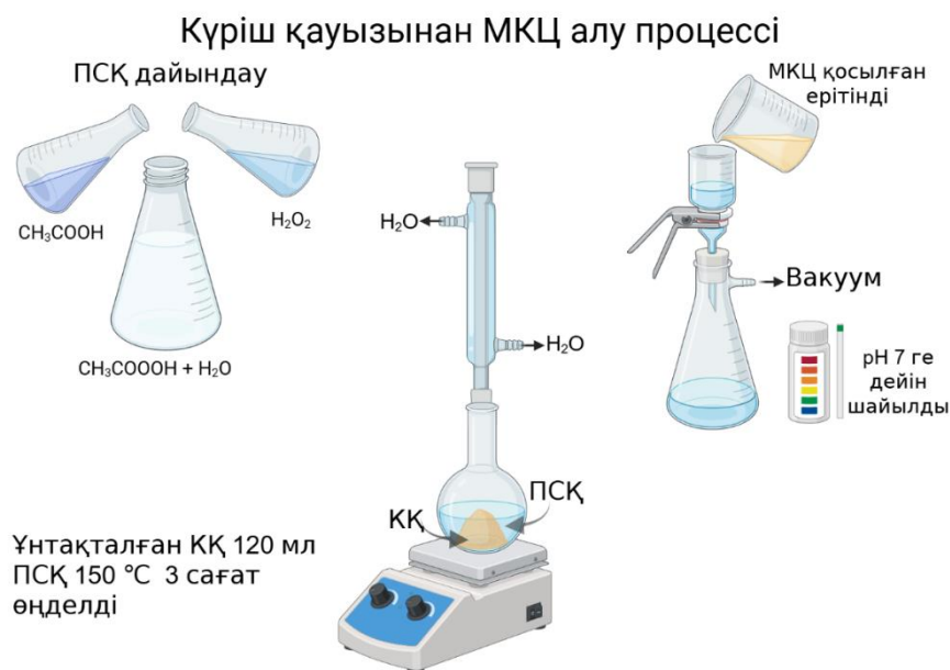
Сурет 2. Биомассаны ПСК-мен өңдеу процесі
