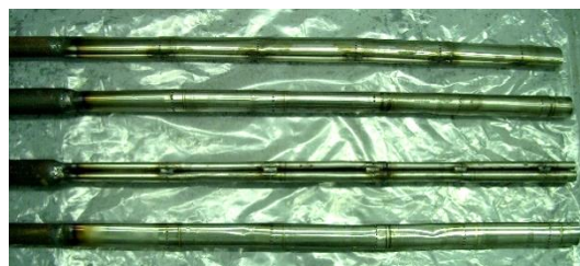
в) жаровые трубы с приваренными инвентарными головками (слева)
