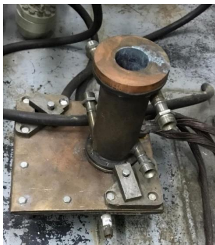
а) кристаллизатор и поддон
