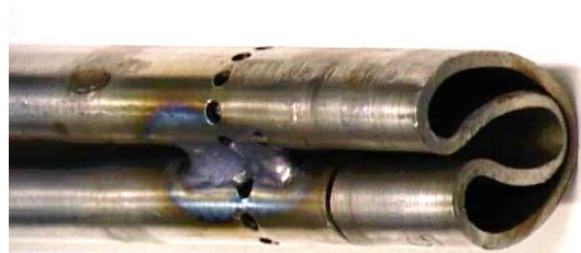
а) жаровая труба в исходном состоянии
