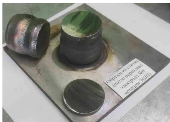
б) результат разделки слитка
