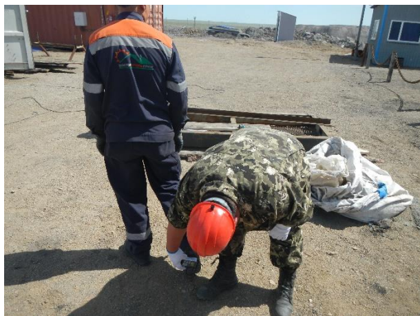
Рисунок 3. Радиометрическое обследование поверхностей спецодежды, спецобуви и кожных покровов работников
