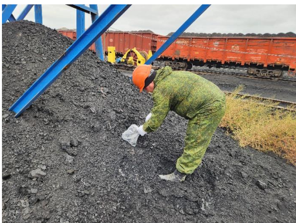
Рисунок 4. Отбор проб и измерение радиационных параметров угля
