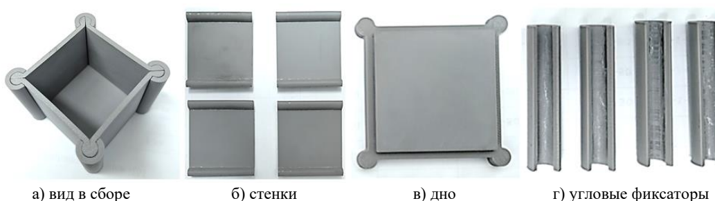
Рисунок 6. Разъемная форма и ее элементы
