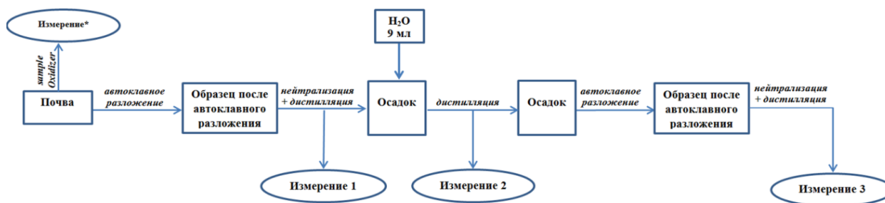
Рисунок 3. Схема определения валового содержания ^3\text{H} в почве
