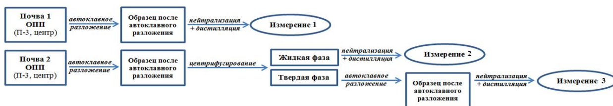
Рисунок 4. Схема эксперимента по выявлению возможных потерь ^3\text{H} на различных стадиях при подготовке методом автоклавного разложения
