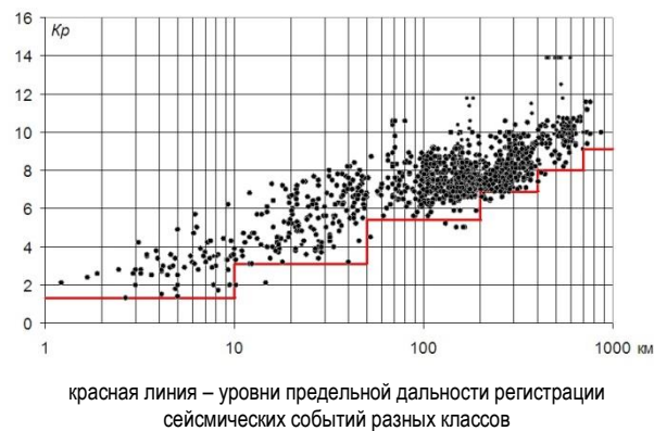
Рисунок 3. Экспериментальная зависимость энергетического класса от расстояния по данным сейсмической сети VMGSR
