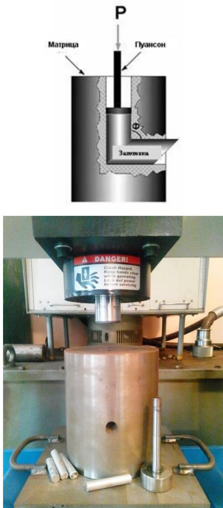
Рисунок 1. Схема проведения РКУП прессования и пресс-оснастка с гидравлическим прессом для интенсивной пластической деформации
