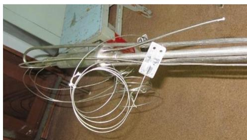
Рисунок 11. Ампульное устройство с образцом литневой КПС
