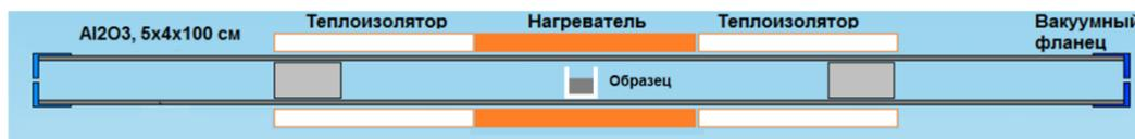
Рисунок 2. Схема расположения элементов рабочей камеры установки CorrSiC’a при насыщении дейтерием образцов литиевой керамики
