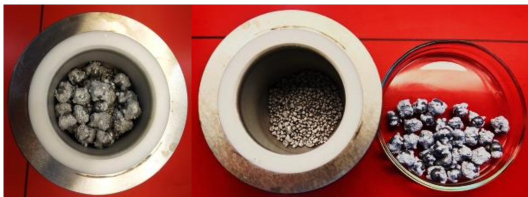
Рисунок 2. Внешний вид порошковой смеси и размольной гарнитуры после ВИ в течение 30 мин
