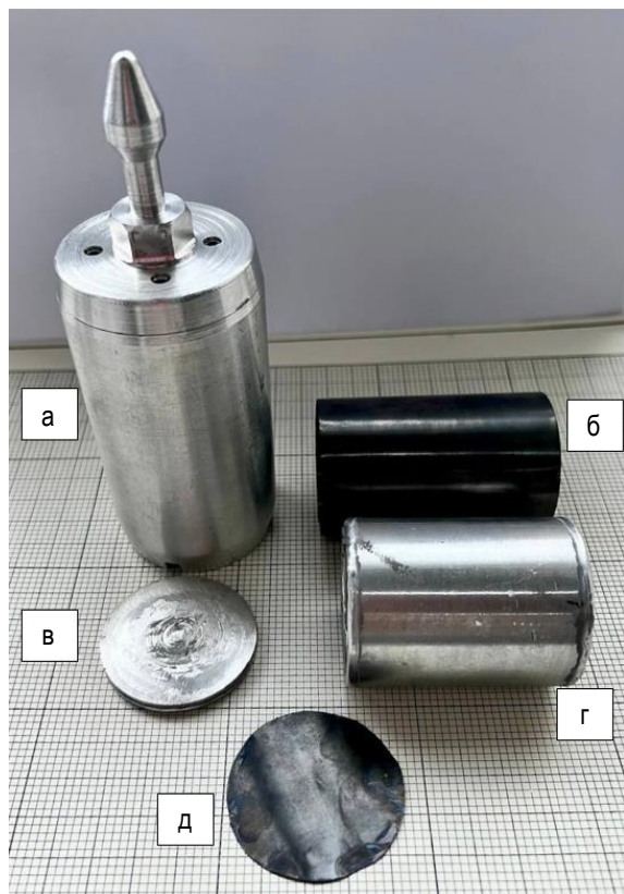
Рисунок 1. Компоненты облучательной капсулы: (а) капсула, (б) боковой экран из тантала, (в) торцевой экран из карбида бора, (г) боковой экран из карбида бора, (д) торцевой экран из тантала
