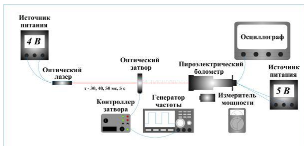
Рисунок 4. Принципиальная схема калибровки пирозлектрического болометра
