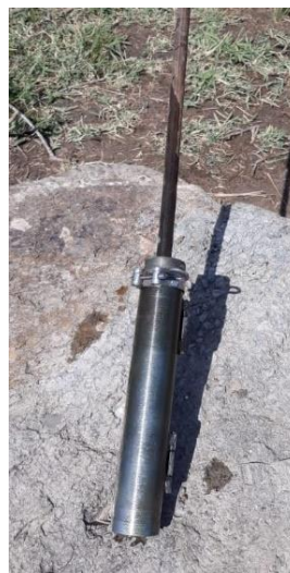
Рисунок 2. Пробоотборник для отбора проб донных отложений в виде колонки
