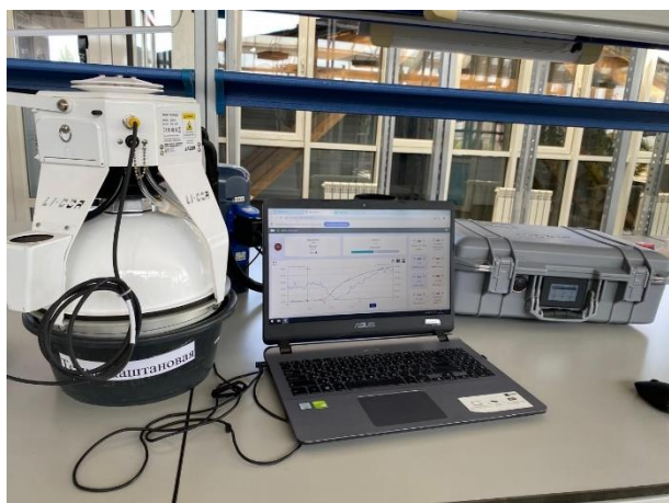
Рисунок 3. Измерение почвенной эмиссии CO 2 .
