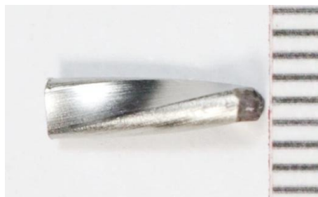
б) спираль (имитатор твэла)
