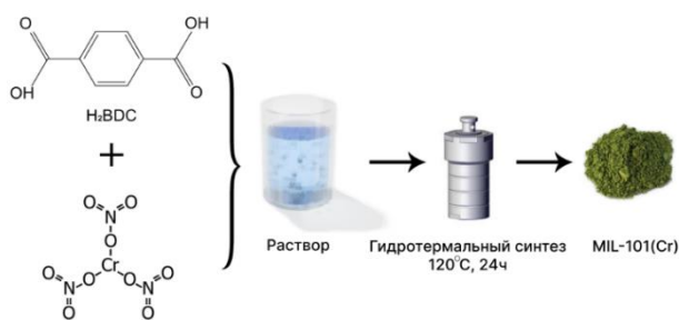
Рисунок 2. Схема получения MIL-101(Cr) гидротермальным методом
