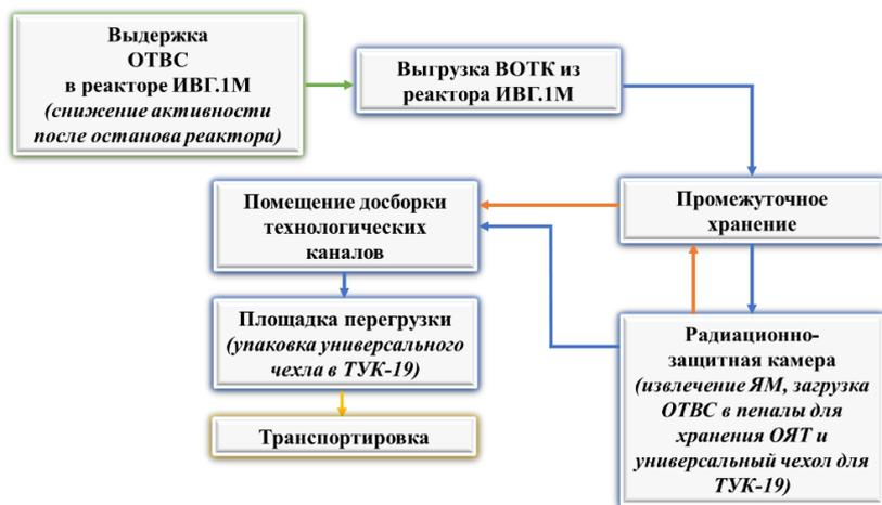
Рисунок 1. Схема транспортно-технологических операций с ОТВС
