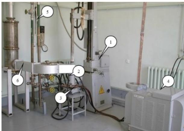
1 – электрошлаковая печь; 2 – кристаллизатор; 3 – поддон; 4 – трансформатор; 5 – система водяного охлаждения и сбора сточных вод; 6 – система автономной вентиляции
