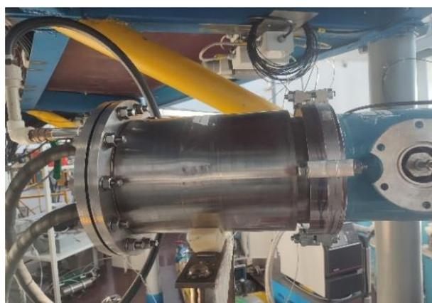
б) изготовленный эквивалент активной нагрузки
