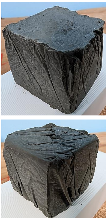
Рисунок 3. Опытный образец ЦМ после извлечения из тестовой формы с полиэтиленом
