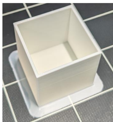
Рисунок 2. Модель и внешний вид напечатанной тестовой формы
