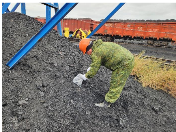
Рисунок 4. Отбор проб и измерение радиационных параметров угля
