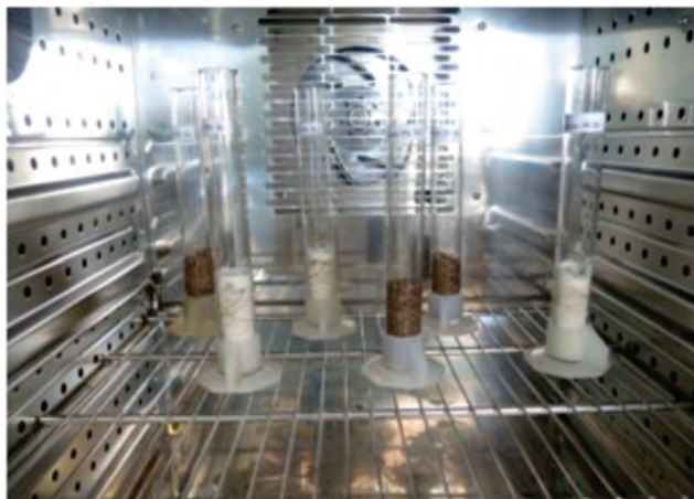
а) Образцы в климатической камере
