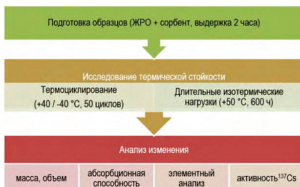
Рисунок 2. Схема исследования термической стойкости
