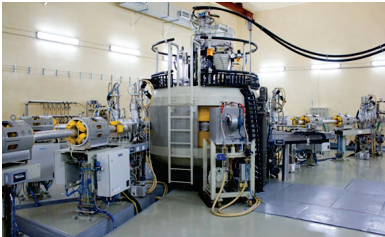
Рисунок 3. – Пример циклотрона централизованного производства C-30
