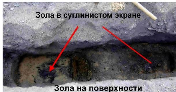
Рисунок 5. Профиль 12, ПК370. Результаты заверки аномальных зон с повышенной поляризуемостью и газопроницаемостью
