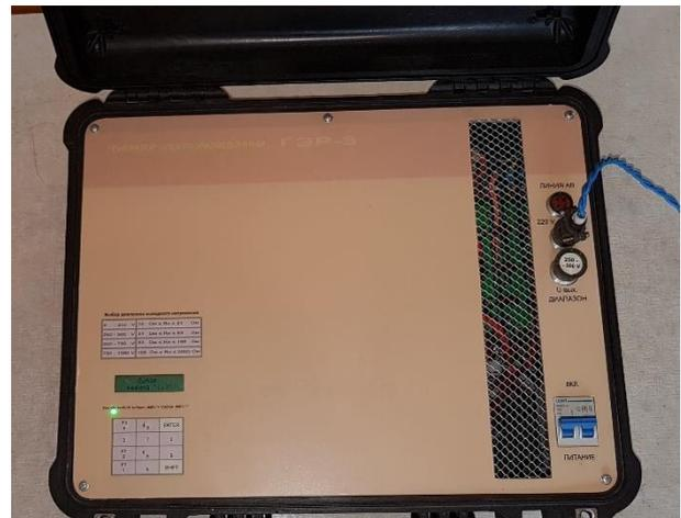
Рисунок 1. Макет экспериментального образца генератора ГЭР-3
