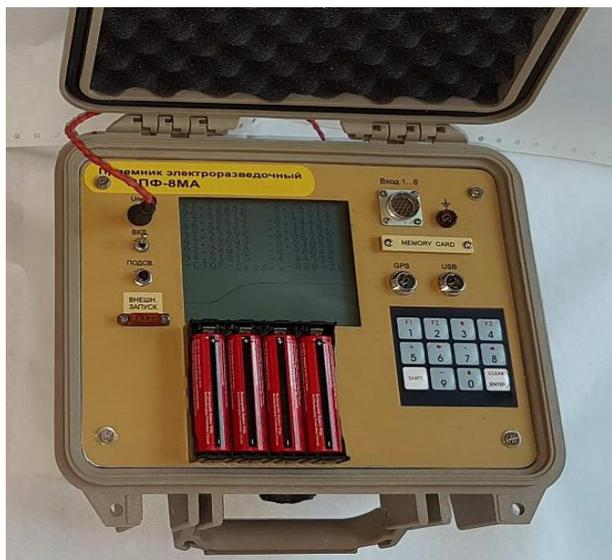
Рисунок 2. Макет экспериментального образца восьмиканального приемника ВПФ-8МА
