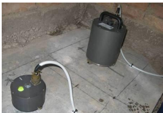
а) сейсмометры (акселерометр CMG-5T – слева, CMG-3ESPC – справа)
