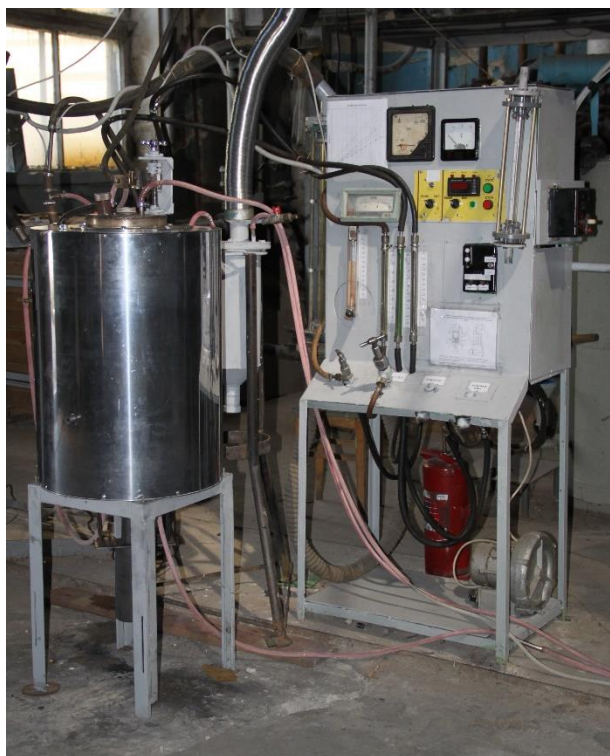
Рисунок 1. Лабораторная установка для высокотемпературной очистки графита
