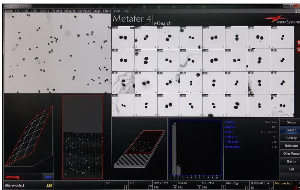
Рисунок 1. Этап автоматической визуализации и фотографирования бинуклеарных клеток при помощи классификатора Micronuclei (Metafer 4/MSearch, MetaSystems, Германия)
