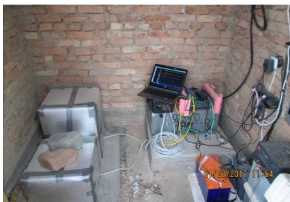
б) сейсмометры: акселерометр CMG-5T, CMG-3ESPC; регистрирующая аппаратура и система питания (по состоянию до ноября 2018 г.)
